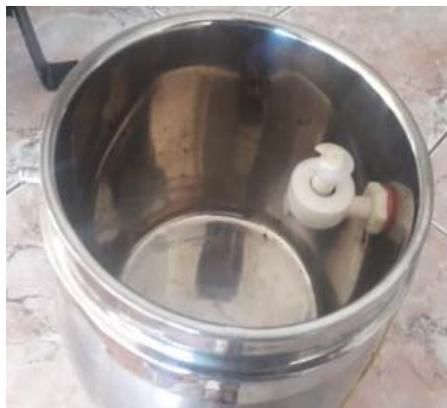
**Figura 12:** Sensor de nivel interno.
